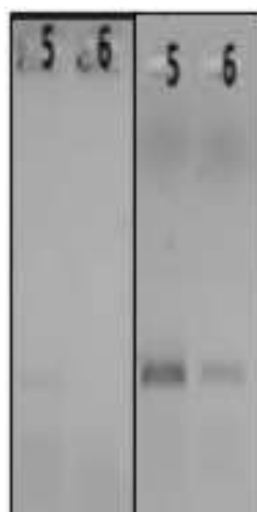
Рисунок 4 – Электрофорез. Нарботка продукта синтеза кДНК единичной клетки с использованием 2 типов частиц: частицы с иммобилизованными баркодированными олигонуклеотидами (слева), частицы с баркодированными олигонуклеотидами со вставкой РС-линкера (справа).
